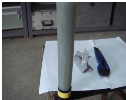
图 4 剥切后绝缘层表面有损伤
