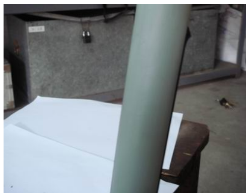
图 3 剥切后绝缘层表面光滑圆整
